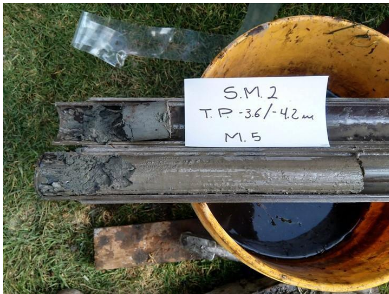
B.12. Inicio del registro de los materiales limosos en el SM-2.
