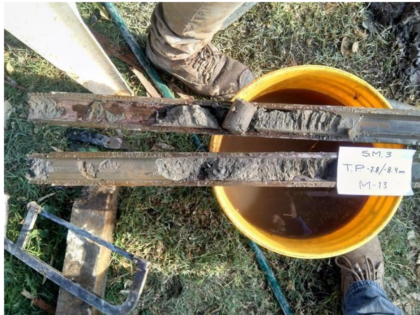
B.22. Limos registrados por debajo del tubo Shelby, se destaca la recuperación de estos, ya que solo se pudo recuperar el 60%.
