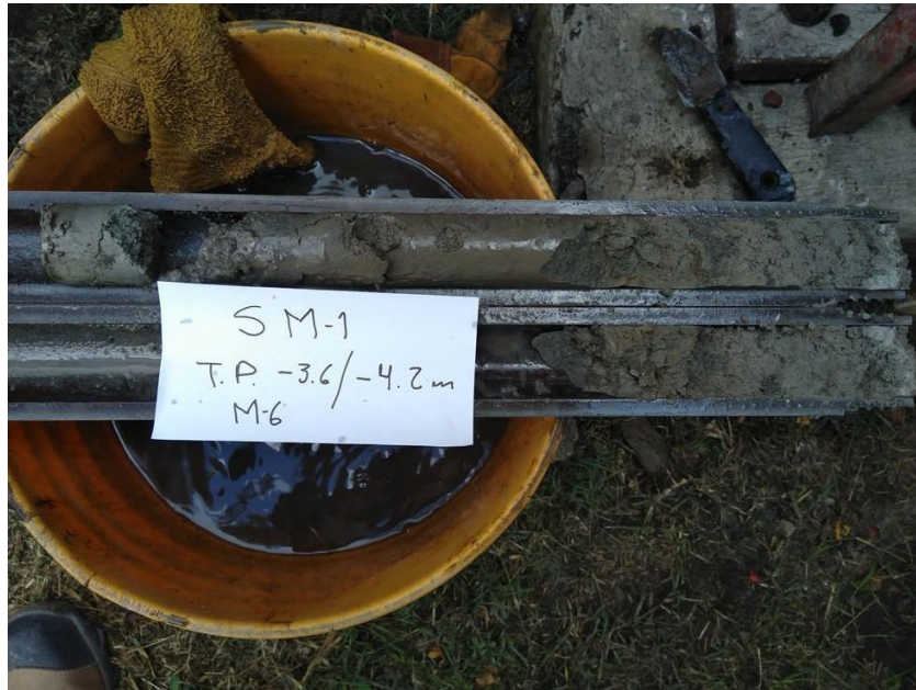
B.3. Muestra donde se registra el cambio de los rellenos hacia los limos.
