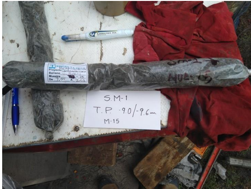
B.7. Todas las muestras obtenidas de manera continua mediante la herramienta de tubo partido, fueron debidamente empaquetadas y etiquetadas.
