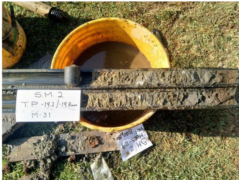
B.18. Ultima muestra obtenida en el SM-2, ya que la muestra del tubo partido M-32 no fue posible recuperarla.
