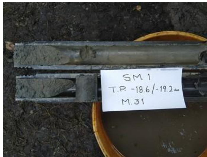
Foto No. 7. Muestras representativas recuperadas del sondeo SM-01.
