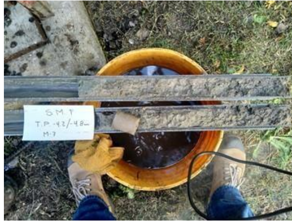
Foto No. 6. Tubo partido con muestra representativa recuperada con tubo partido para realizar su descripción en sitio.
