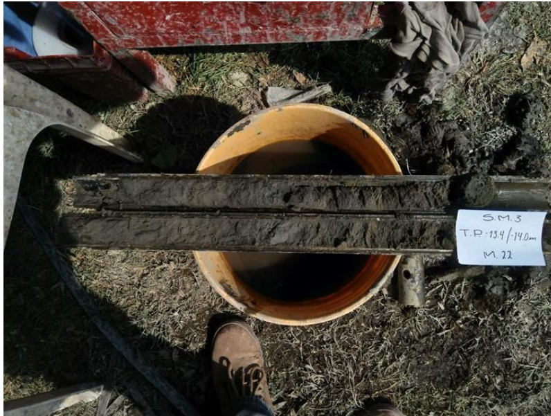
B.25. Limos y suelo sepultado obtenido por debajo de la muestra de tubo Shelby a la profundidad de 13.40 metros en el sondeo Sm- 3.
