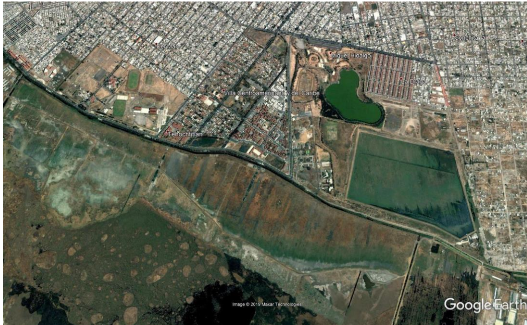
Figura No. 11. En esta imagen del año 2005 es posible observar que se registran procesos de hundimiento diferencial en la zona donde se encontraba el antiguo lago destacando el comportamiento del terreno de manera semejante a los rasgos topográficos mostrados en el MDT del apartado de Geomorfología del presente trabajo. Este comportamiento del terreno como ya se hizo mención, se debe al contenido heterogéneo de materiales en el suelo y subsuelo.
