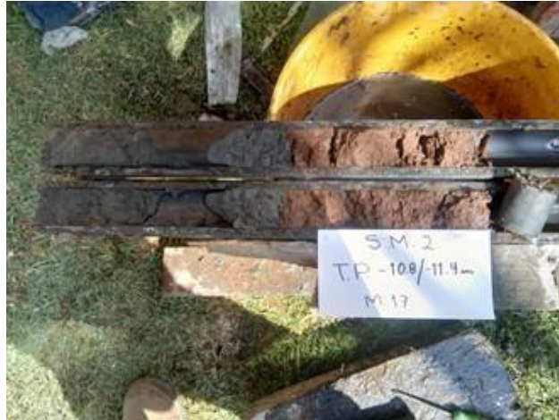
Foto No. 11. Durante los trabajos de exploración del subsuelo en el sondeo SM-2, fue posible observar que los contactos entre horizontes de limos arenosos se registraban de manera discordantes reflejando cambios radicales en la depositación.
