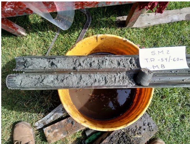
B. 14. Limos registrados inmediatos a la toma del primer tubo Shelby del SM-2.
