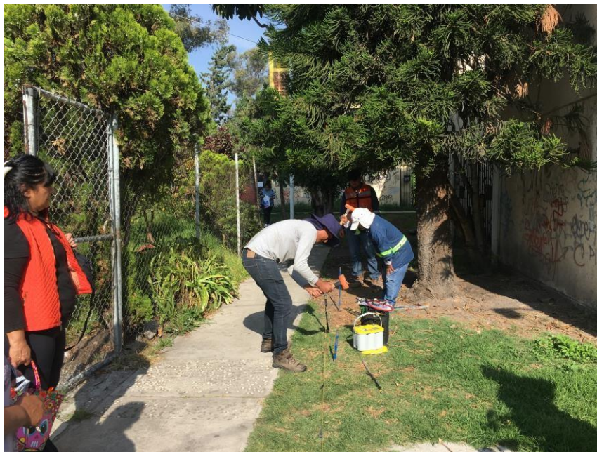
A.22. Ejecución del SEV-3.
