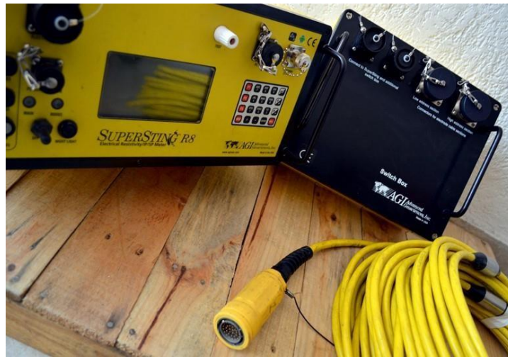
Figura No. 18. Equipo de Exploración geoelectrica.
