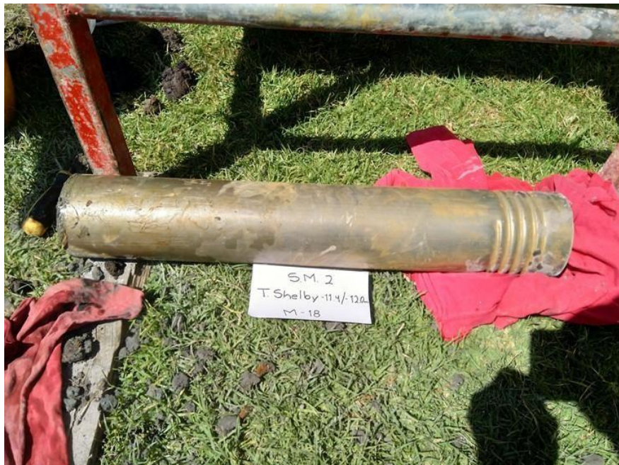
B.16. Segundo tubo Shelby del sondeo SM-2.
