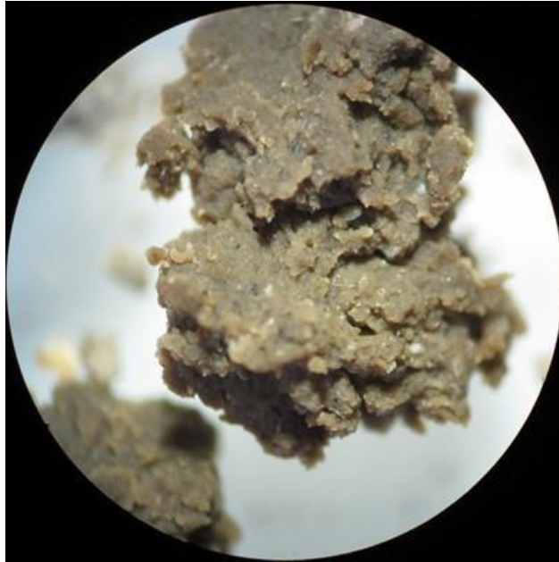
Foto No. 13. El limo analizado está compuesto de minerales característicos de una fuente volcánica de tipo basáltica, por lo que se pudo observar que las muestras presentaban ferromagnesianos, biotitas, plagioclasa, vidrio, cuarzo, los cuales se asocian a restos de organismos.
