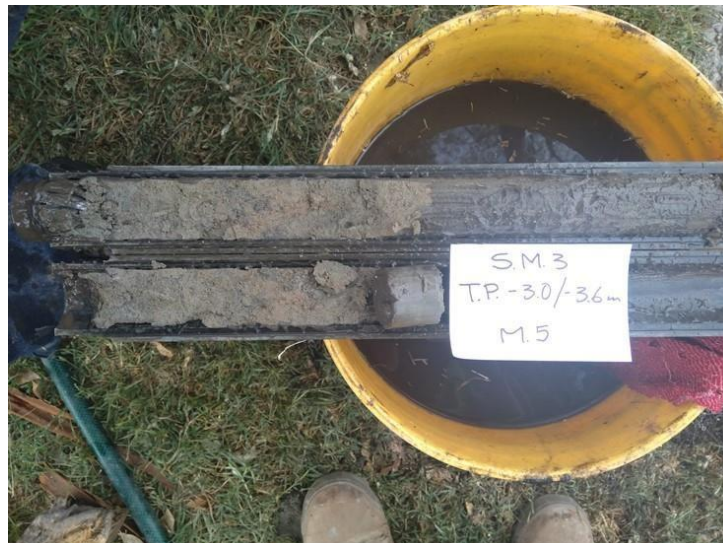
B.20. Arenas con limos en la parte superficial del SM-3.
