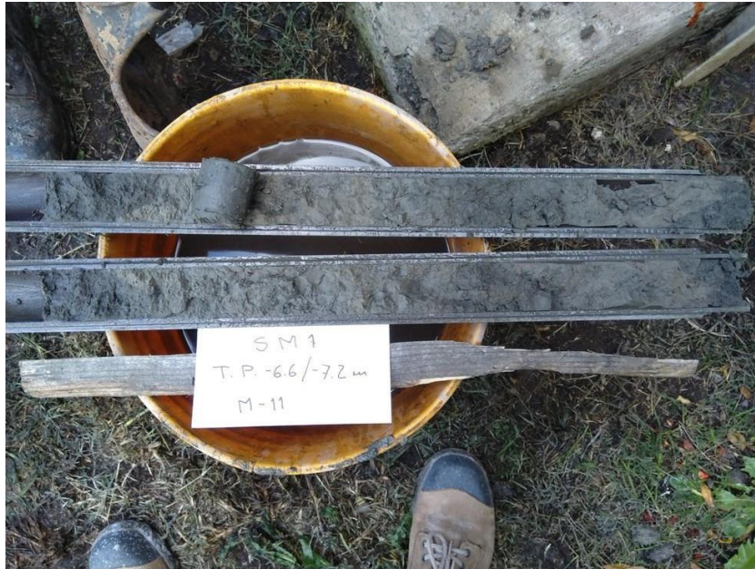
B.5. Se muestra a los limos registrados inmediato al primer tubo Shelby del SM-1.
