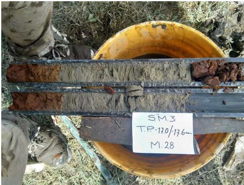
B.25. Limos y suelo sepultado obtenido por debajo de la muestra de tubo Shelby a la profundidad de 13.40 metros en el sondeo Sm- 3.
