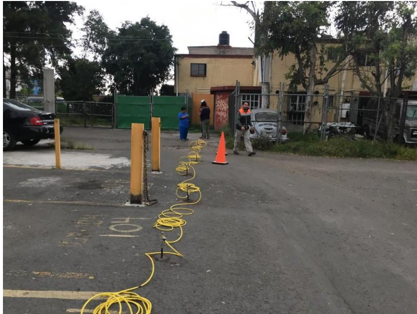
A.9. Realización de la Línea de D-D 3 dentro del acceso contiguo a Calle Pie de la Cuesta.
