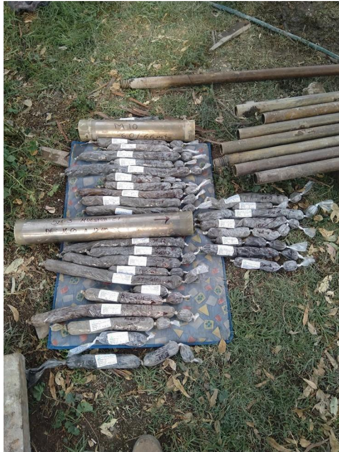
B.29. Se muestran las 30 muestras de tubo partido y las dos muestras de tubo Shelby obtenidas durante los trabajos del sondeo SM-3.
