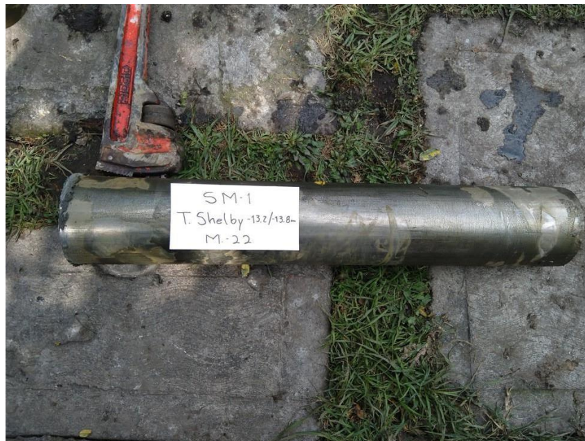
B.8. Tercera muestra de tubo Shelby obtenida durante los trabajos de exploración en el SM-1.
