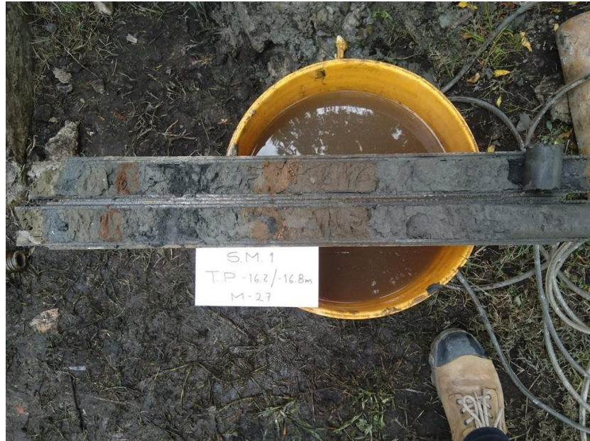
B.9. Se observan variaciones importantes en los materiales a partir de los 15.00 metros de profundidad.
