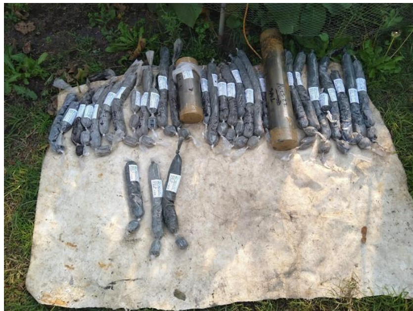
B.10. Se muestran las 30 muestras de tubo partido y los tres tubos Shelby del SM-1.
