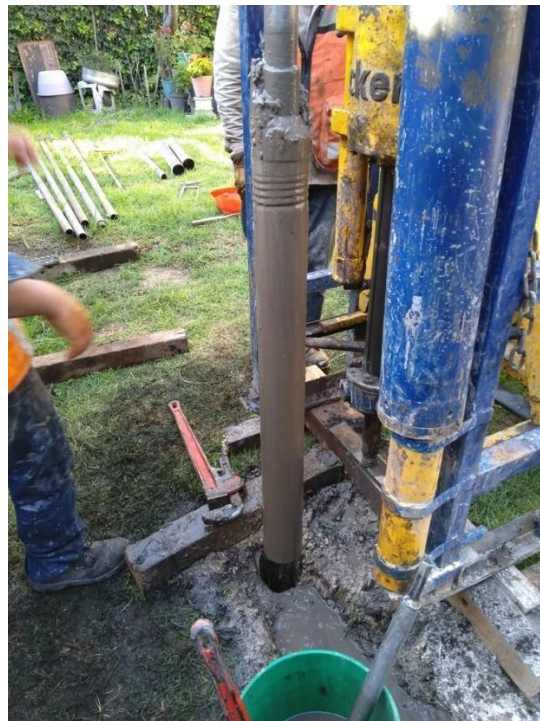
B.4. Obtención del tubo Shelby a la profundidad de 6.00 a 6.60 metros en el SM-1.
