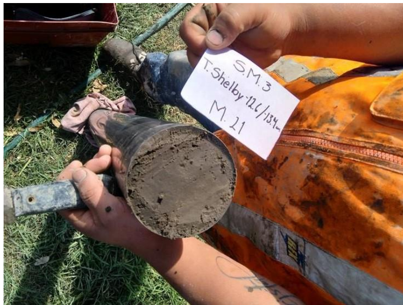
B.24. Segundo tubo Shelby del sondeo SM-3.
