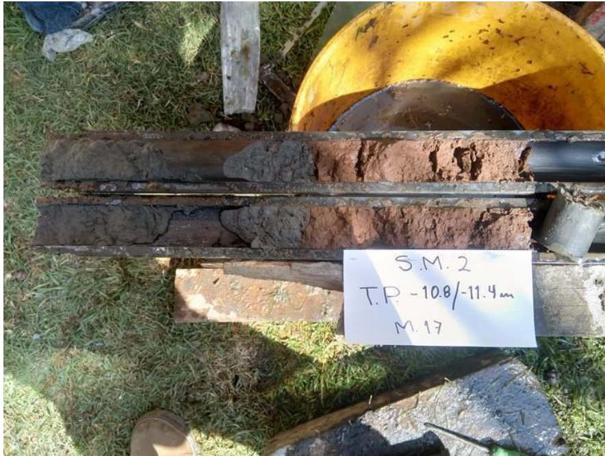
B.15. Registro de cambios en los materiales limosos.
