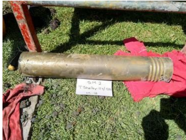
Foto No. 10. Se muestra uno de los dos tubos Shellys obtenidos durante los trabajos del SM-2.
