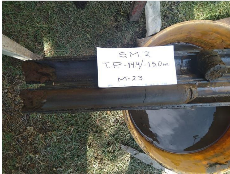
B.17. Limos con mayor cantidad de arcilla con alto contenido de agua, los cuales fueron perforados solo con el peso de la herramienta.
