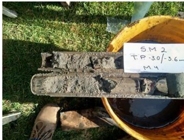
Foto 9. Muestras de suelo y núcleos de roca recuperados en el SM-02
