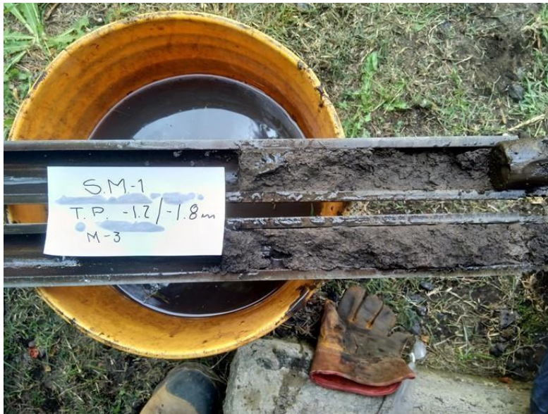
B.2. Muestra de los rellenos mediante la herramienta de tubo partido.
