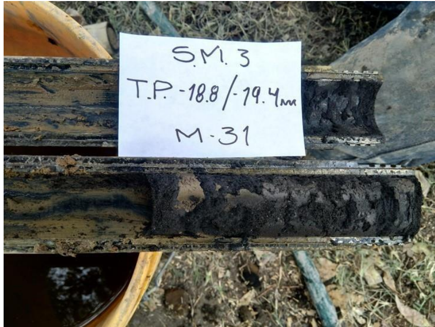
B.27. Muestra de limo arenosos con alto contenido de materia orgánica y agua por lo que no fue posible la recuperación de estos.
