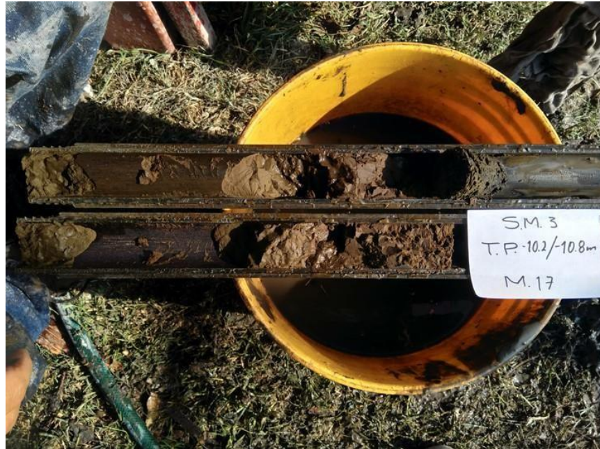
B.23. Material con muy poca resistencia, ya que se registraba un número de golpes de 1 (uno) para perforar los 60 centímetros del tubo partido.
