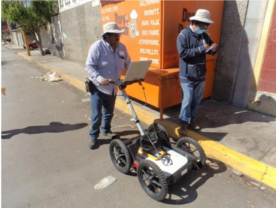
FOTOGRAFÍA 7 Exploración con GEORADAR (antena de 250 MHz), Línea 4 F1.
