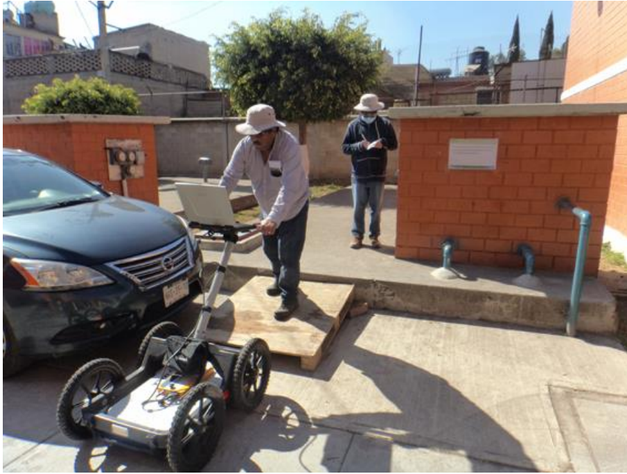
FOTOGRAFÍA 5 Exploración con GEORADAR (antena de 250 MHz), Línea 3 F1.
