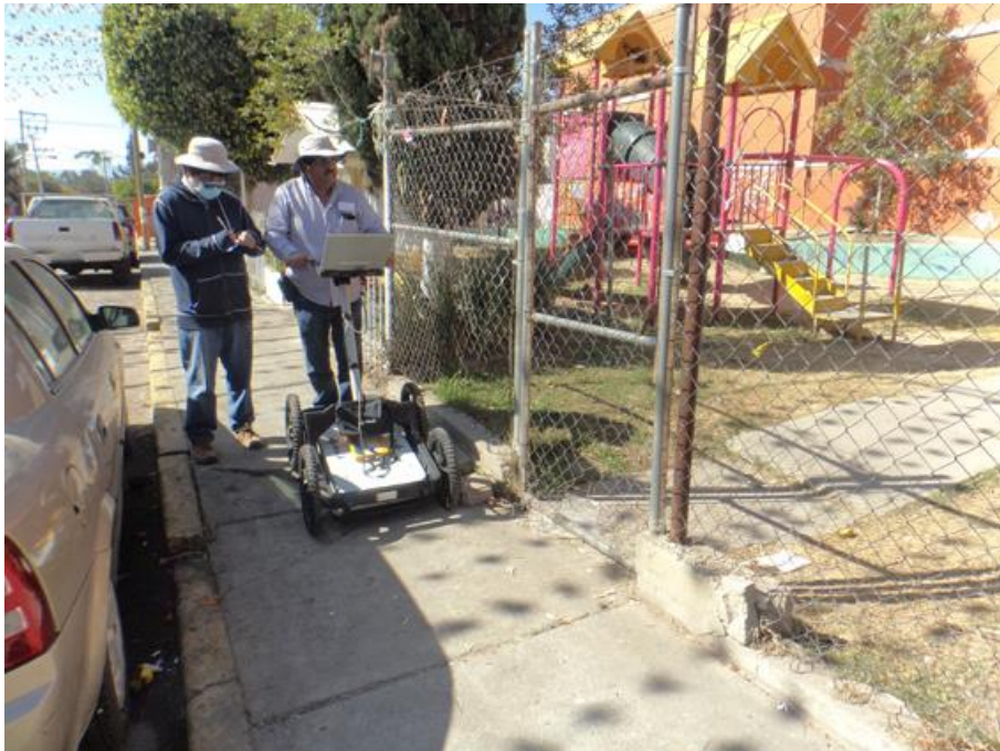
FOTOGRAFÍA 8 Exploración con GEORADAR (antena de 250 MHz), Línea 4 F2.
