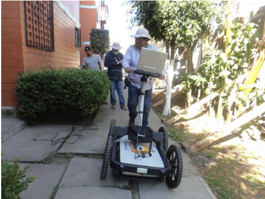
FOTOGRAFÍA 4 Exploración con GEORADAR (antena de 250 MHz), Línea 2 F2.
