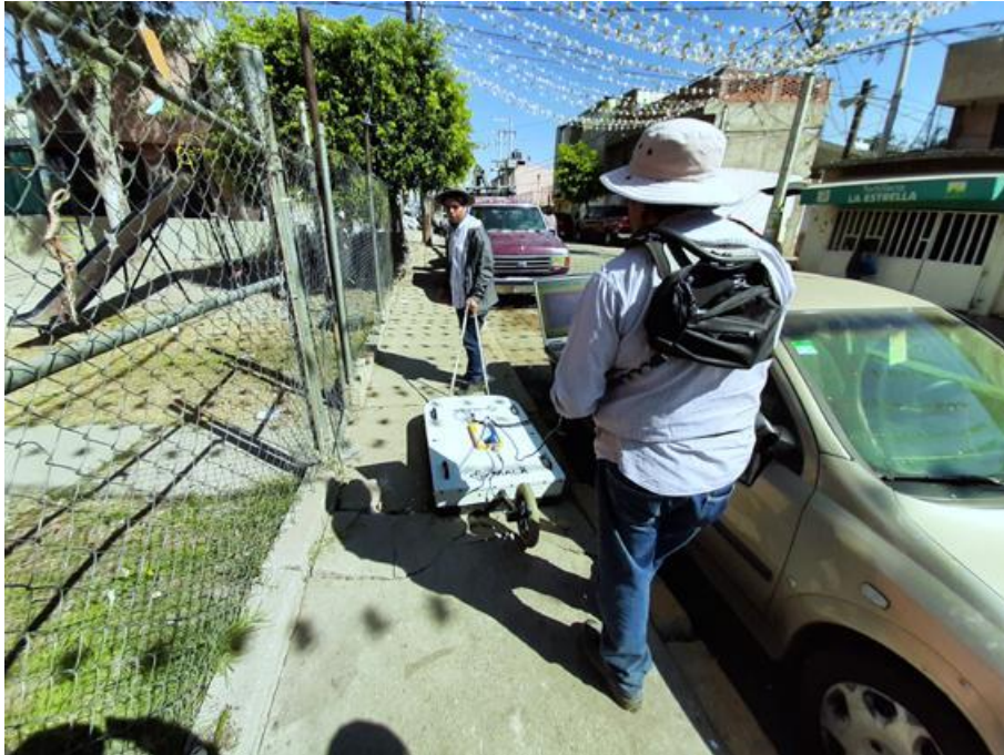
FOTOGRAFÍA 16 Exploración con GEORADAR (antena de 100 MHz), Línea 4 F2.
