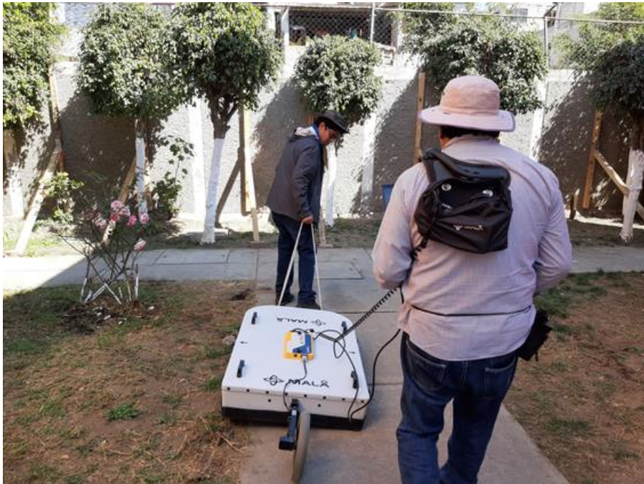
FOTOGRAFÍA 14 Exploración con GEORADAR (antena de 100 MHz), Línea 3 F2.
