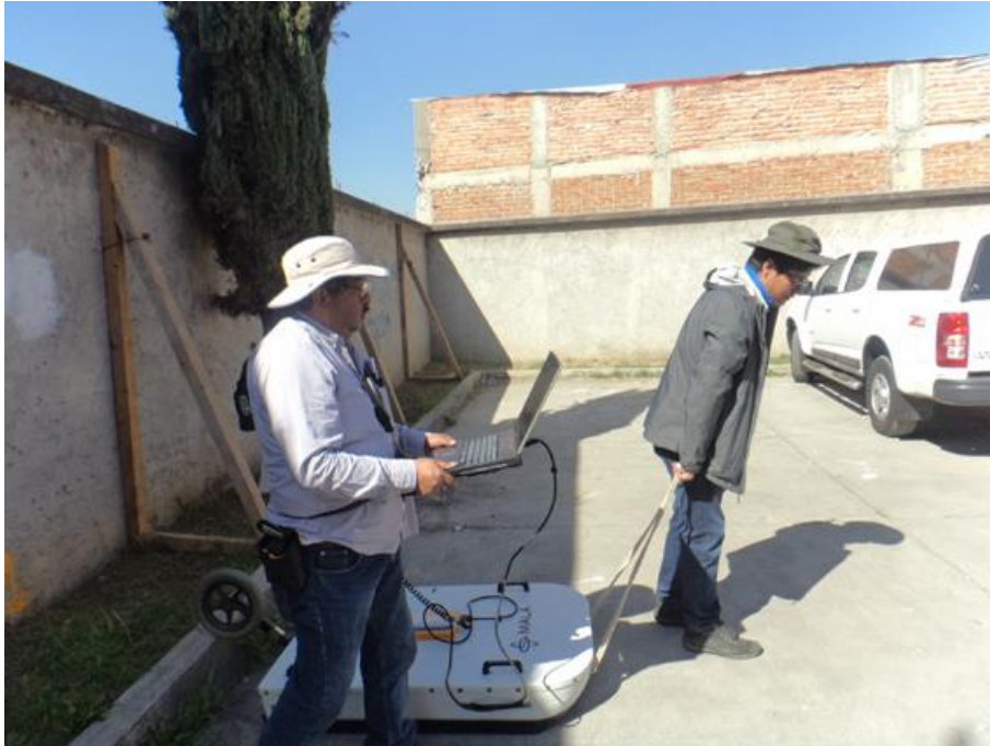
FOTOGRAFÍA 9 Exploración con GEORADAR (antena de 100 MHz), Línea 1 F1.
