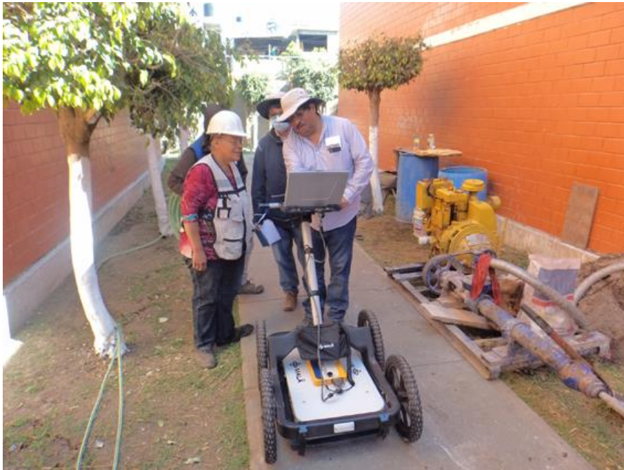
FOTOGRAFÍA 6 Exploración con GEORADAR (antena de 250 MHz), Línea 3 F2.
