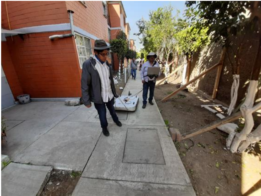
FOTOGRAFÍA 12 Exploración con GEORADAR (antena de 100 MHz), Línea 2 F2.
