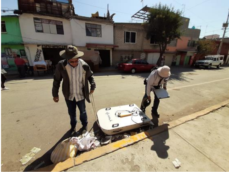
FOTOGRAFÍA 15 Exploración con GEORADAR (antena de 100 MHz), Línea 4 F1.
