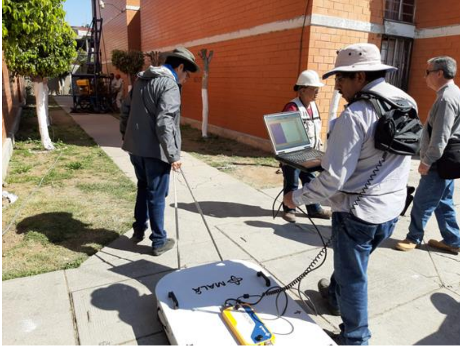
FOTOGRAFÍA 13 Exploración con GEORADAR (antena de 100 MHz), Línea 3 F1.
